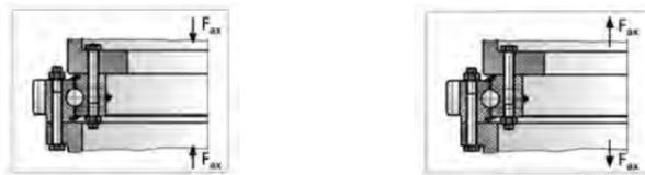
**3.4. MONTAGGIO DEL CUSCINETTO DI BASE/SLEWING RING FITTING**
